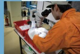
成形した製品を顕微鏡で確認します。温度や湿度の僅かな変化で歪んでしまうのでしっかりと確認します。
