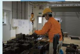
金型はクレーンを使って移動させます。金型は数多く、一つ一つ形が違うので間違えないよう気を付けます
